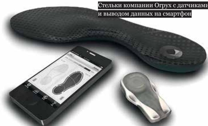
Стельки компании Огрук с датчиками и выводом данных на смартфон
